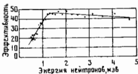
Рис.2. Энергетическая зависимость эффективности регистрации нейтронов счетчиком
