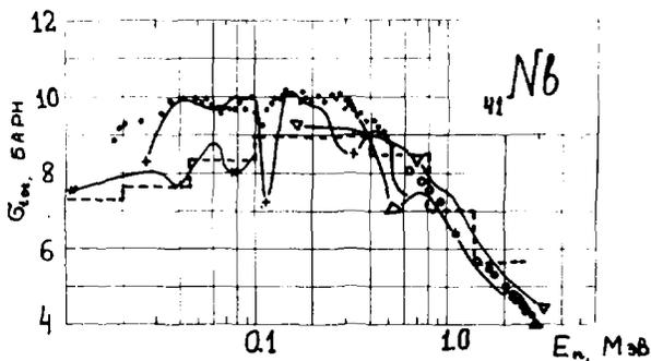
Рис.5. Сравнение полученных значений полного нейтронного сечения с измерениями других авторов (взято по атласу [4])
