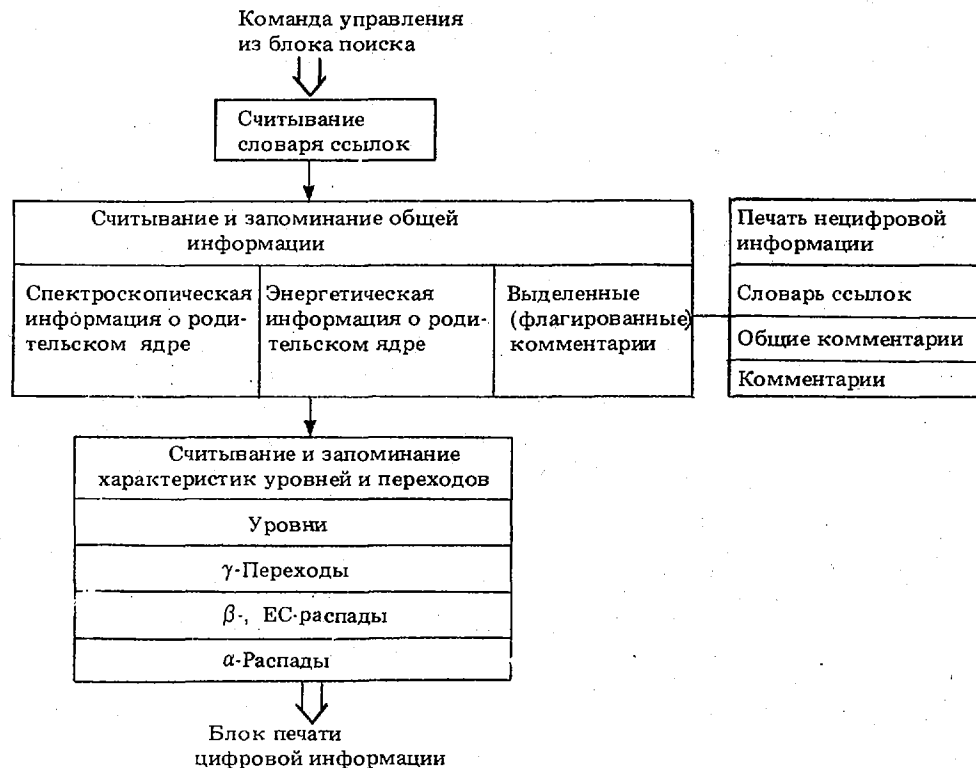
Рис. 4. Схема работы блока считывания информации из набора данных программы СУПЕР
