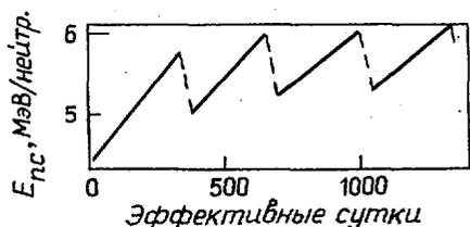
Рис. I. Энерговыделение (сплошные кривые) при захвате нейтронов без деления в ходе четырех первых кампаний реактора ВВЭР-440 (пунктирная кривая - перегрузка реактора)
