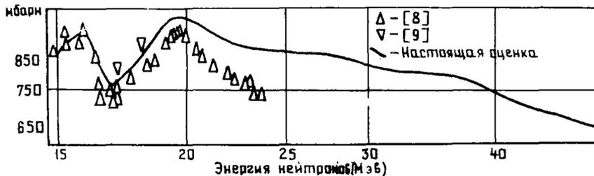
Рис.3. Сечение упругого рассеяния.
