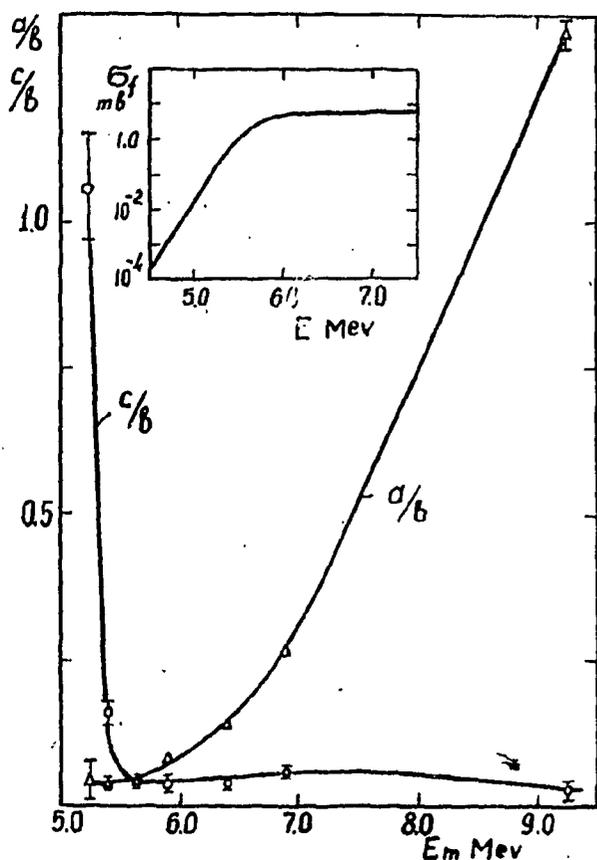
Рис. 3. Зависимость отношения коэффициентов  $a/b$  и  $c/b$  от максимальной энергии  $\gamma$ -квантов тормозного излучения. На вставке изображен энергетический ход сечения фотоделения  $U^{238}$  в районе порога.
