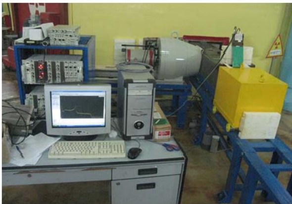
Fig. 10. BGO-HPGe Compton suppression spectrometer.
