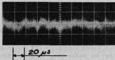
FIG. 12. Luminosité du plasma mesurée avec un photomultiplicateur
